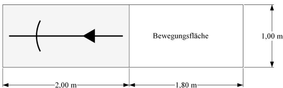
Schematische Darstellung eines Fahrradabstellplatzes bei ebenerdiger Aufstellung
